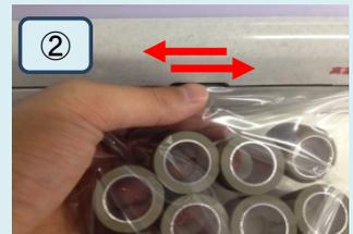
(コツ3) トップカバーを閉める際は、低めの作業台で体重をかけるようにして閉めていただくと楽にできます。
